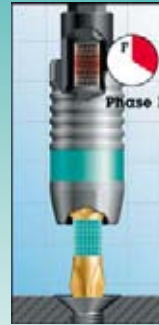
Vaihe 1: Pienempää momenttipiikkiä vaimentaa pitimen joustoalue.
