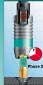
Vaihe 2: Voimakkaampaa momenttipiikkiä vaimentaa ruuvauskärjen joustoalue.
